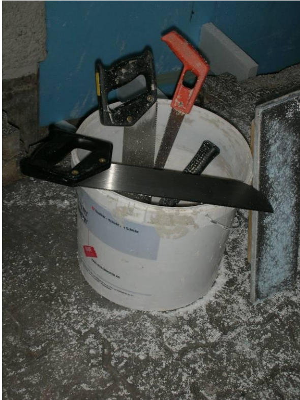
Werkzeuge zum Anpassen der Isolationsplatten, verschiedene Sägen und eine Raspel.
